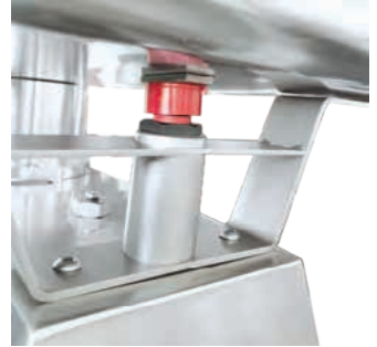
Tramoggia con Micron Hopper with Microswitch Trémie avec Microrupteur Trichter mit Mikroschalter Tolva con Microinterruptor de seguridad Воронка с Микровыключателем
